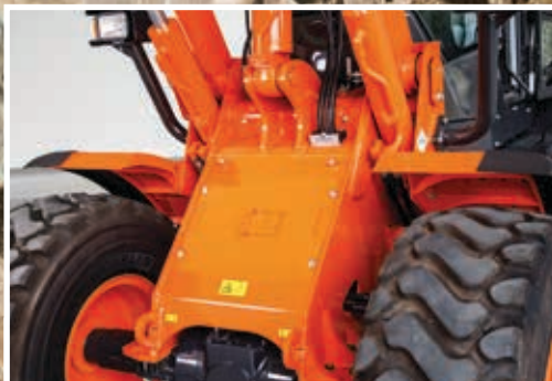
Přední rám nakladače ZW150-6 byl zpevněn.
