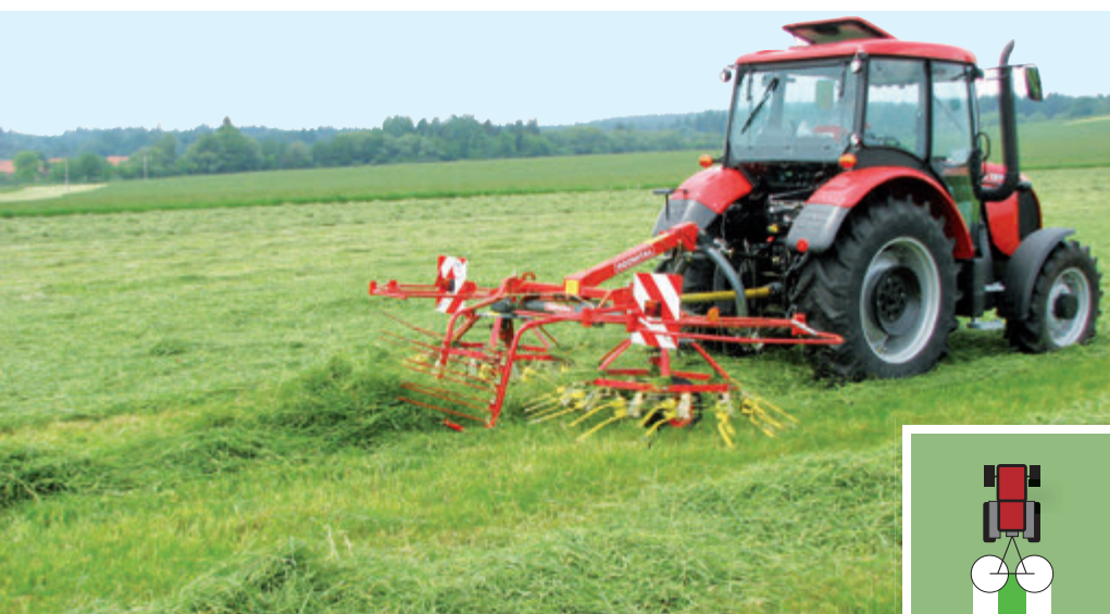
Shrnování - prutové stěny jsou v pracovní poloze
