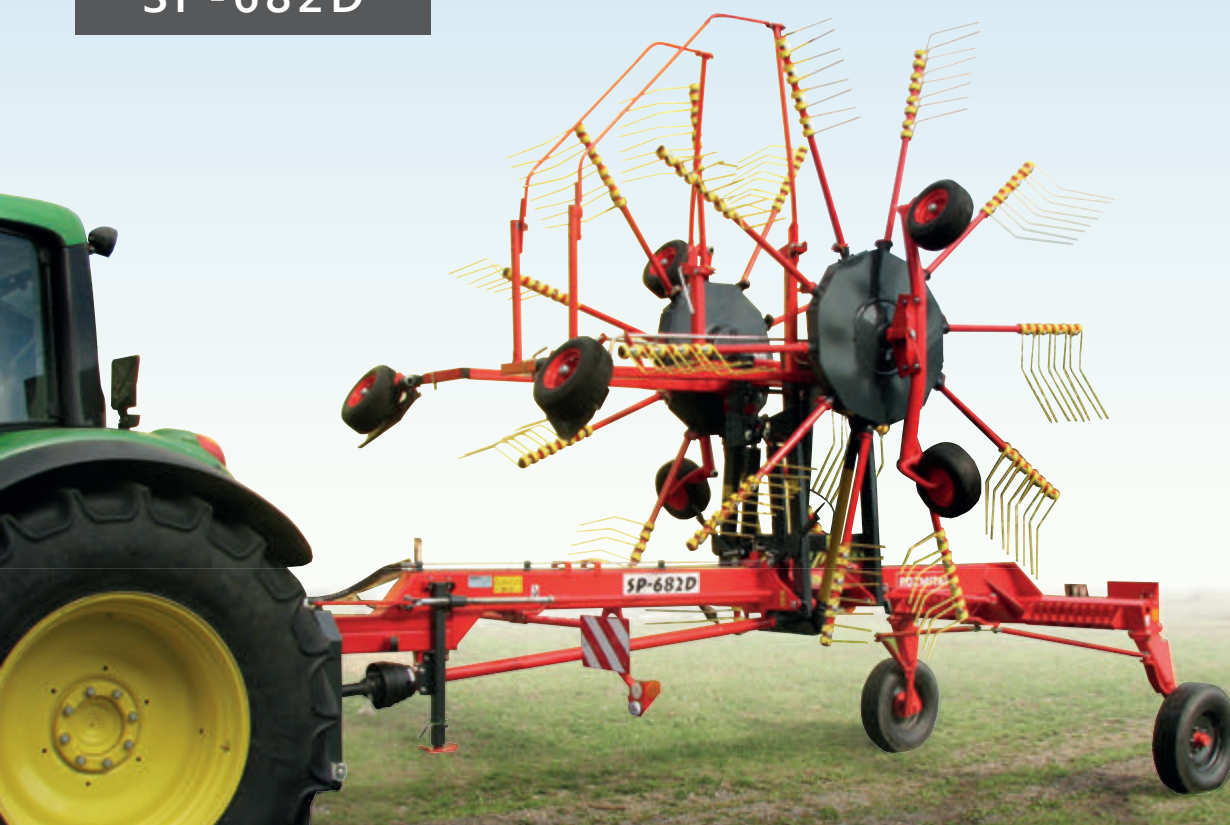
SP - 682D dvourotorový shrnovač na prostřední řádek s pevným pracovním záběrem
