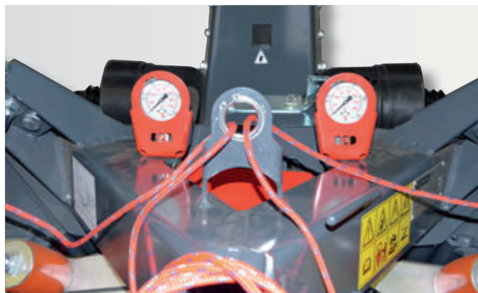
Hydropneumatické nadlehčování je součástí standardního vybavení.
