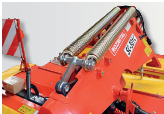
Nadlehčování lišty pomocí pružin.
