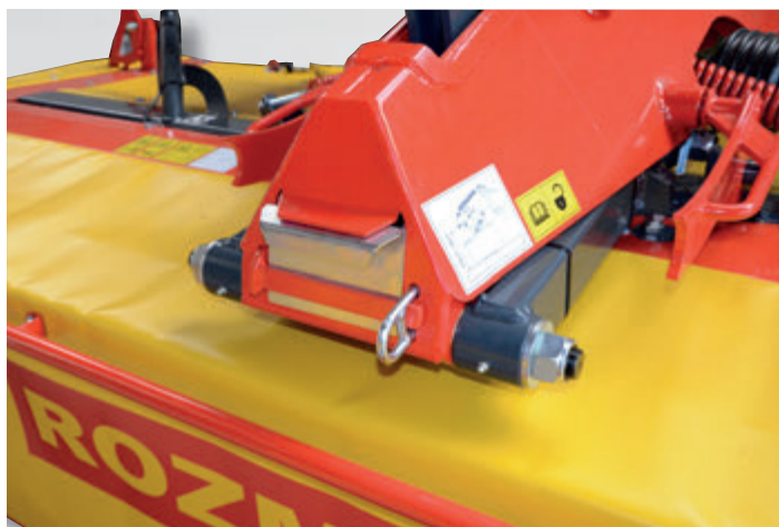
Páka na rychloupínání nožů a skladovací prostor pro náhradní nože.
