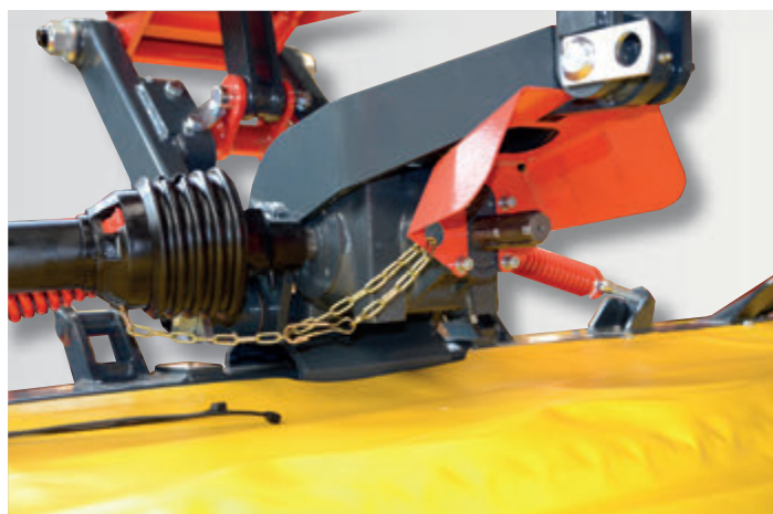
Vstupní převodovka , standardní nastavení z výroby je pro traktory s čelním náhonem s otáčením po směru hodinových ručiček, při pohledu na převodovku ve směru jízdy. Převodovku lze přestavit do jiné polohy.
