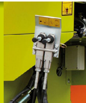
Comandi meccanici flessibili a distanza (standard per Husky MT)
